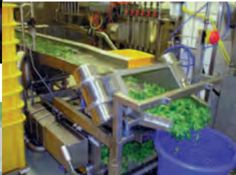
Fördersiebrinne, angetrieben mit Edelstahl-Elektro-Außenvibratoren
