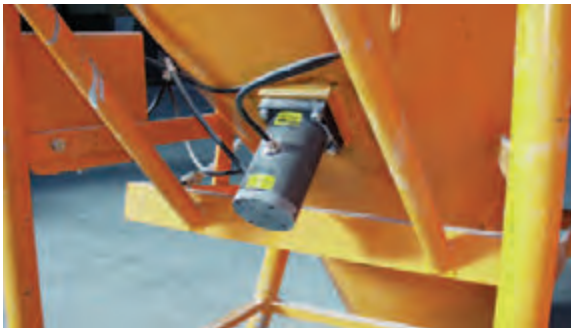
Austragshilfe am Behälter
