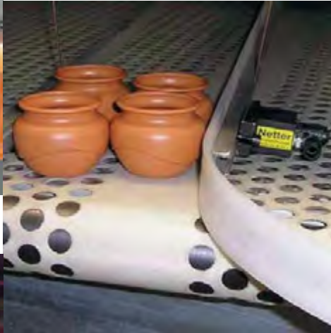
Vermeiden von Produktstaus mit Druckluft-Kreisschwingern
