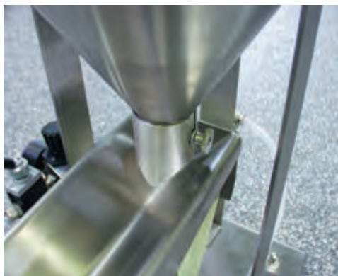
Dosierstützen am Behälterausschlauf
